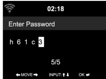
**Zum Eingeben des Passwortes** drehen Sie den rechten Drehknopf zum gewünschten Zeichen. Die Pfeil-Tasten benutzen Sie, um weitere Zeichen einzugeben. Erst wenn Sie das Passwort vollständig eingegeben haben, drücken Sie den Drehknopf zur Bestätigung der Eingaben.
